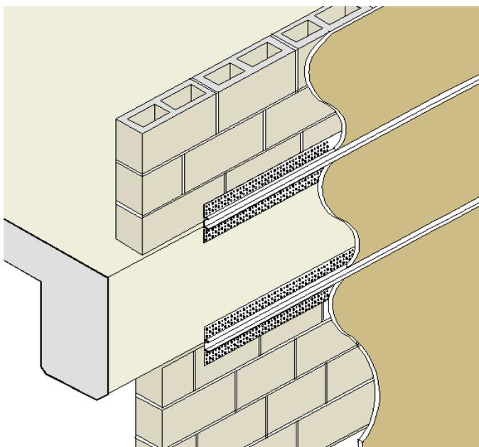
**Usos:** Control de fisuras y grietas en juntas frías de muros trabes, losas y plafones. Contracciones y dilatación por temperatura y vibraciones.
