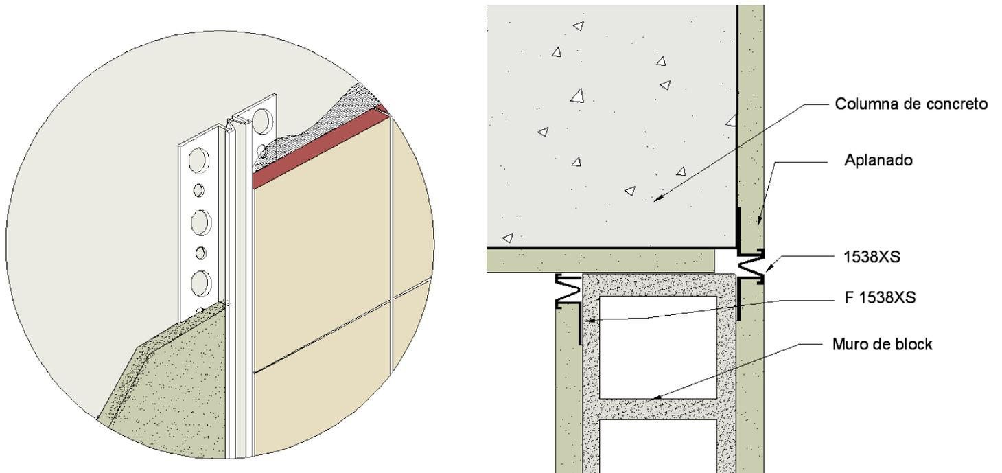
Como junta de control en tableros de fibrocemento de 8mm
