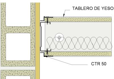
Remates de todo tipo con perfil CTR 50 se obtiene un perfilado limpio y perfecto sobre cualquier otro tipo de sistema o acabado.
