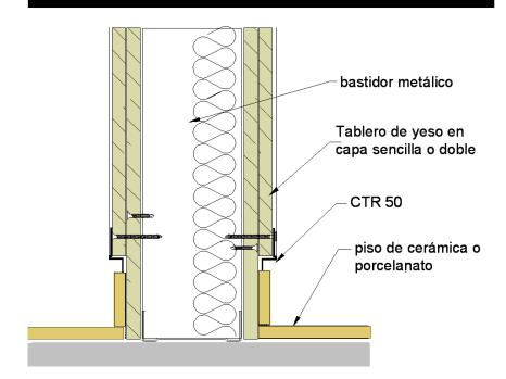
Remates zoclos sobre ensambles de doble hoja, elimina así la diferencia de espesores además de proteger el tablero inferior de golpes y deterioro.
