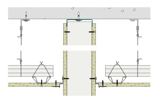
El uso del perfil CTR permite crear plafones de ultimo diseño y calidad a una velocidad impensable pues elimina el fastidio del crear la "buña" u los elementos que con ella conllevan, pues el delineado, limpieza y pintado de la buña se eliminan en un solo paso con el perfil CTR 50
