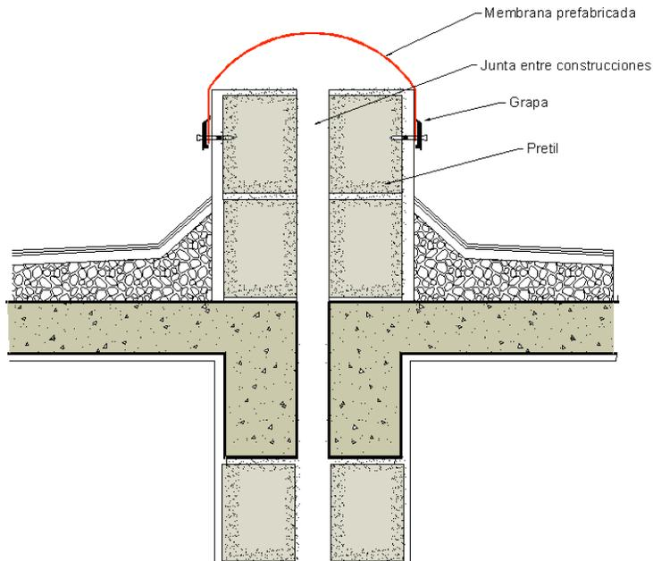
Soluciones a continuación de membrana en vivienda o edificaciones con juntas constructivas
