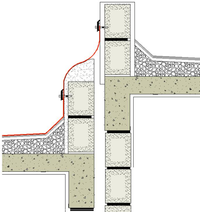
Soluciones a diferentes niveles de juntas constructivas entre edificaciones
